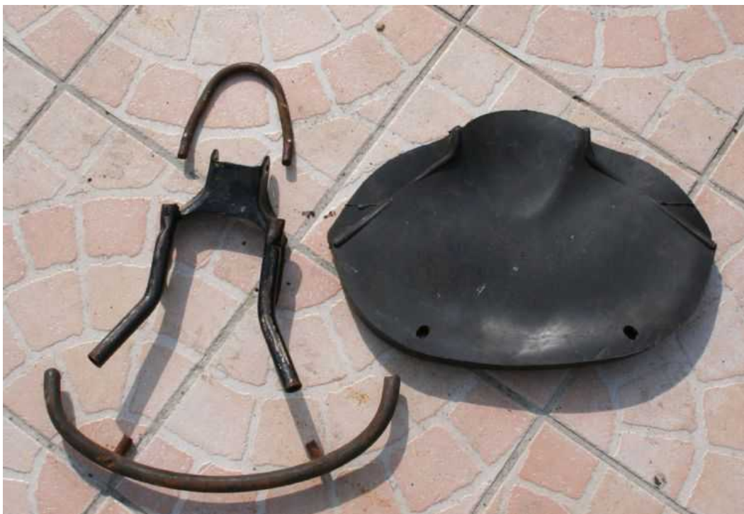
Voici les différents éléments composant la selle (armature + caoutchouc).
