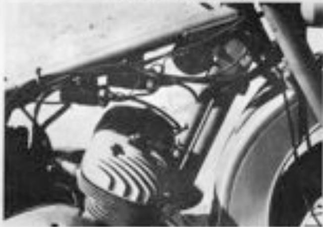
Et ce n'était l'allure des cyclistes, les apparences nous feront penser à 330 Peugeot, avec sa longue pipe d'émission en T. Remarquez la fixation massive du garde-boue avant.
